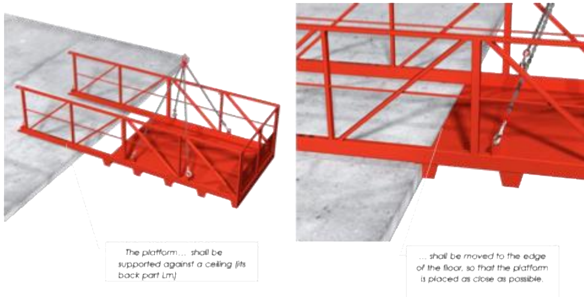
Obr. 3 – Postup montáže: přisunutí plošiny k okraji podlaží (vlevo) a opření o strop (vpravo)
